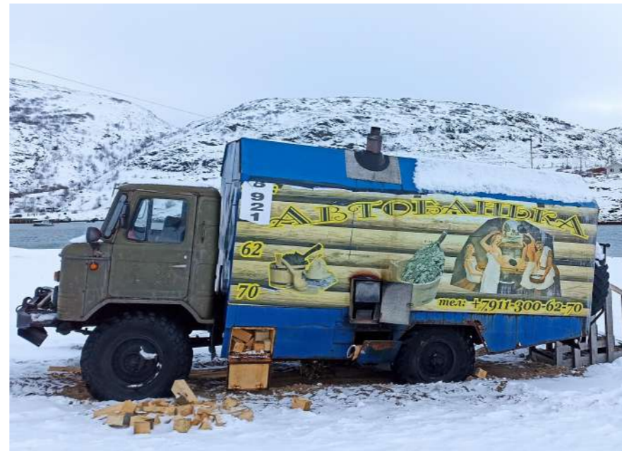
Плохо. Для облицовки использована баннерная ткань
